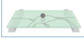
2 x yarı temperli camdan yapılmış lamine güvenlik camı - tüm camlar kırık
